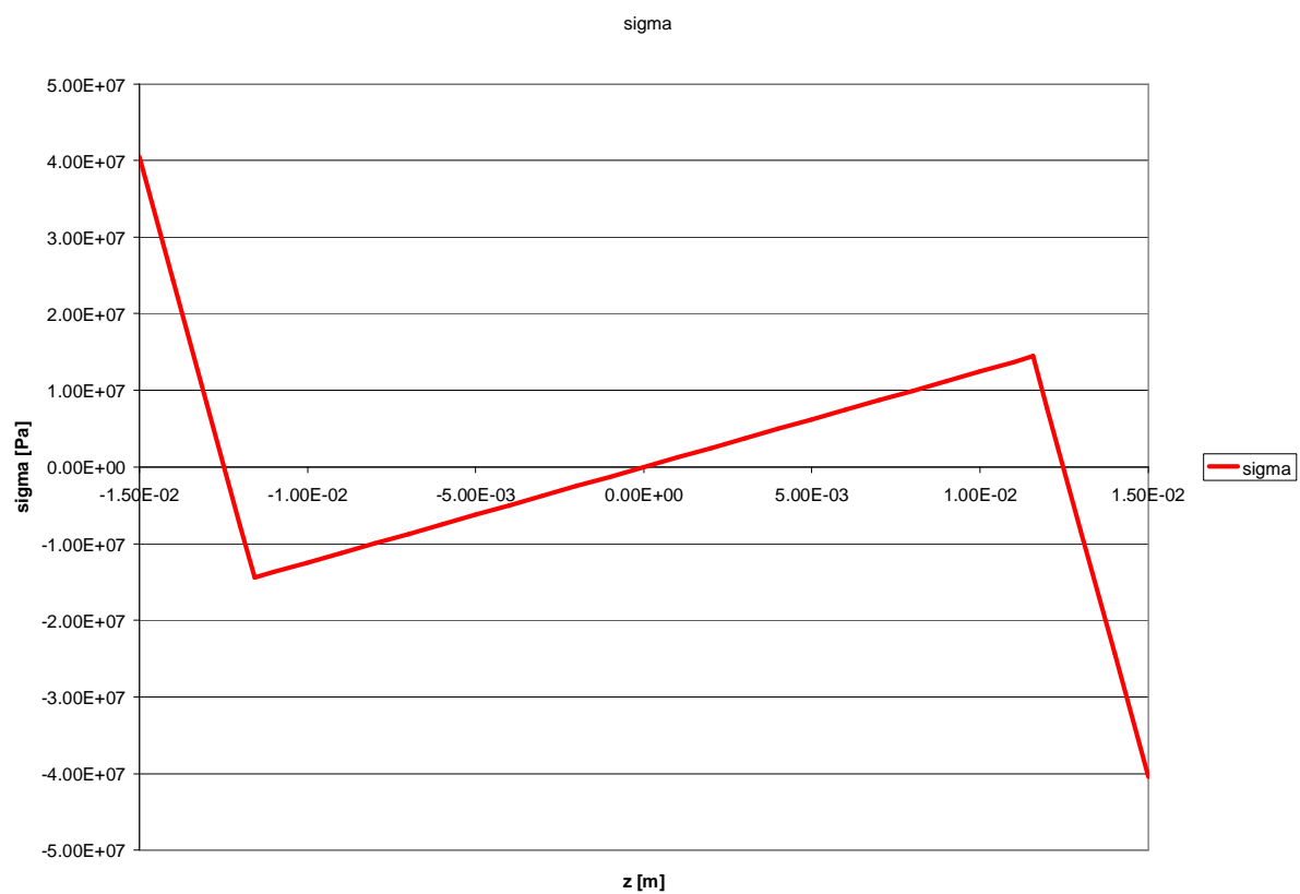
Obr. 20. Průběh napětí při odlehčení
