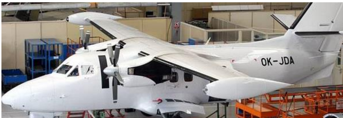
Obrázek 2: "Novější" L410 s 2 palivovými nádržemi na koncích křídel
